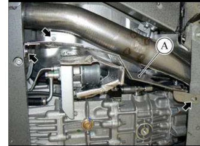
● 重新安装右侧排气管中部上方的右前隔热罩 (A)，拧紧指示的三个紧固件。
