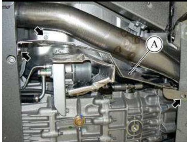
● 拆下右侧排气管中部上方的右前隔热罩 (A)，松开指示的三个紧固件。
